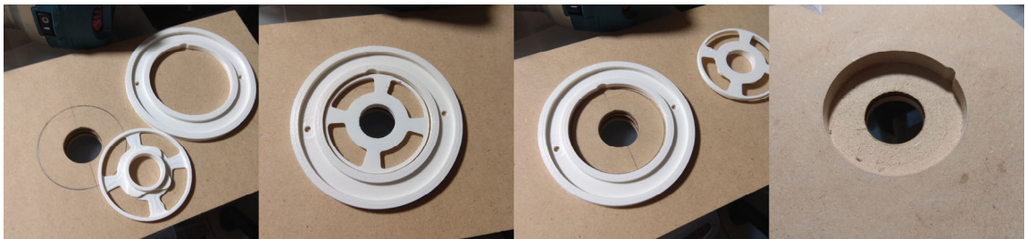
3D Εκτυπωμένο template για καθοδήγηση του ρούτερ στην διάνοιξη πατούρας για διακόπτη, με εξάρτημα ευθυγράμμισης
