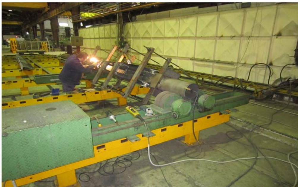
Συγκόλληση βραχίονα στην περιστρεφόμενη καλίμπρα – Συγκόλληση καπακιών με διαφράγματα
