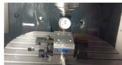
Ευθυγράμμιση και σταθεροποίηση της διάταξης
