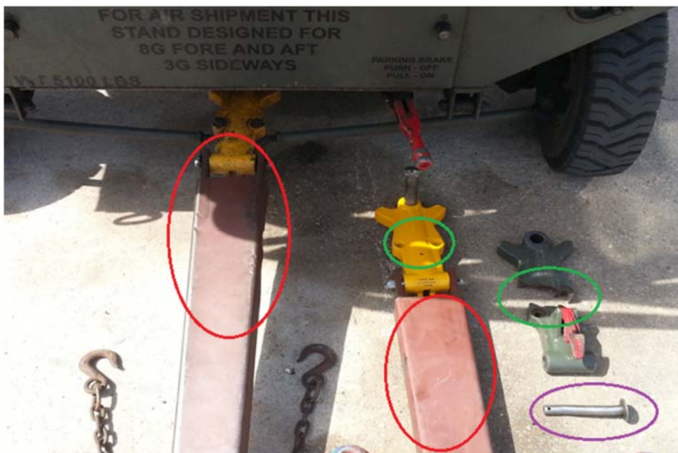
Στρεβλώσεις σε μπάρα ρυμούλκησης, πείρο και θραύση βραχίονα
