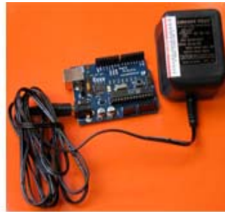
Εξωτερική τροφοδοσία από μετασχηματιστή AC/DC
